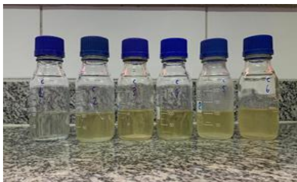
Figura 5 - Procedimento de preparo das amostras da praia do Araçagi com reagente Colilert em frascos de vidro.
