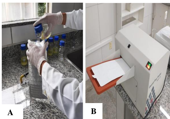
Figura 6 - Procedimento de análise com uso da cartela Quanti-Tray e selagem no Quanti-Tray Sealer Model.
