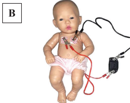
Figura 1. Ilustração da adaptação do transmissor cardíaco codificado Polar® H7 utilizado para coleta da VFC em prematuros. A vista anterior da conexão com o H7, B vista posterior da conexão com o H7. Fonte: arquivo pessoal dos autores (2020).
