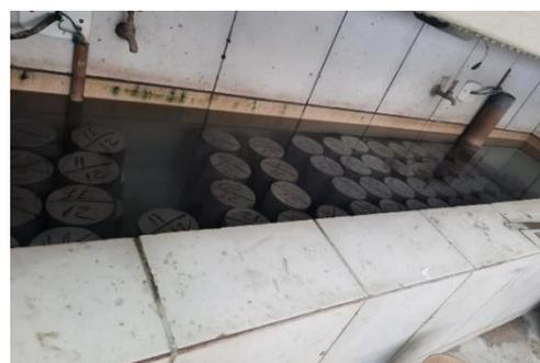
Figura 3 – Tanque para cura dos corpos de prova.
