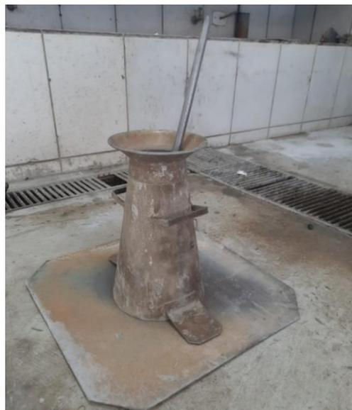
Figura 2 – Ferramentas utilizadas no *Slump test*.
