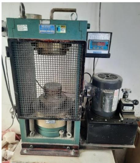
Figura 4 – Prensa hidráulica para rompimento de corpos de prova.
