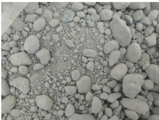
Figura 1 – Amostra de RCD utilizada para a realização dos ensaios.
