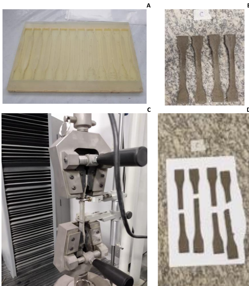
Figura 5 – A - Molde para teste de alongamento, B - Corpos de provas de uma das marcas analisadas., C - Máquina de ensaios Kratos Série KE e D - Corpos de provas de uma das marcas analisadas após o teste.
