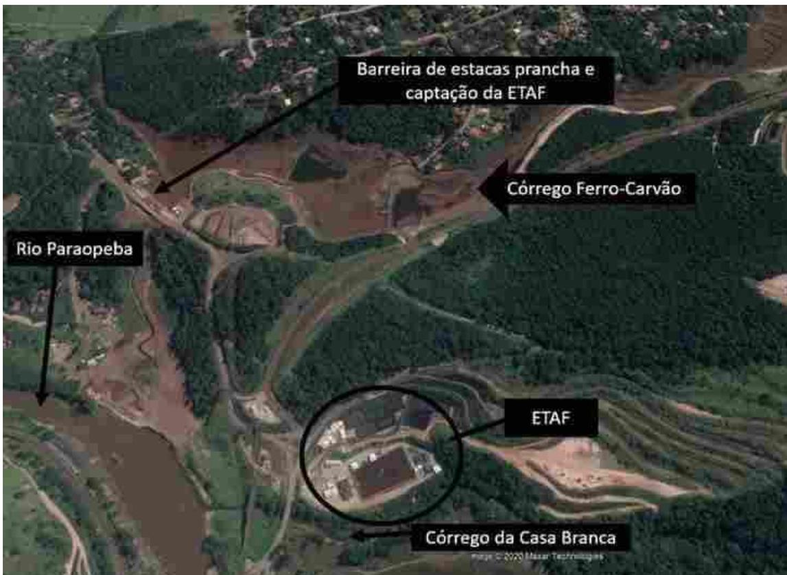
Figura 4 - Barreira de estacas prancha e captação. Referência: Google Earth, 2019.
