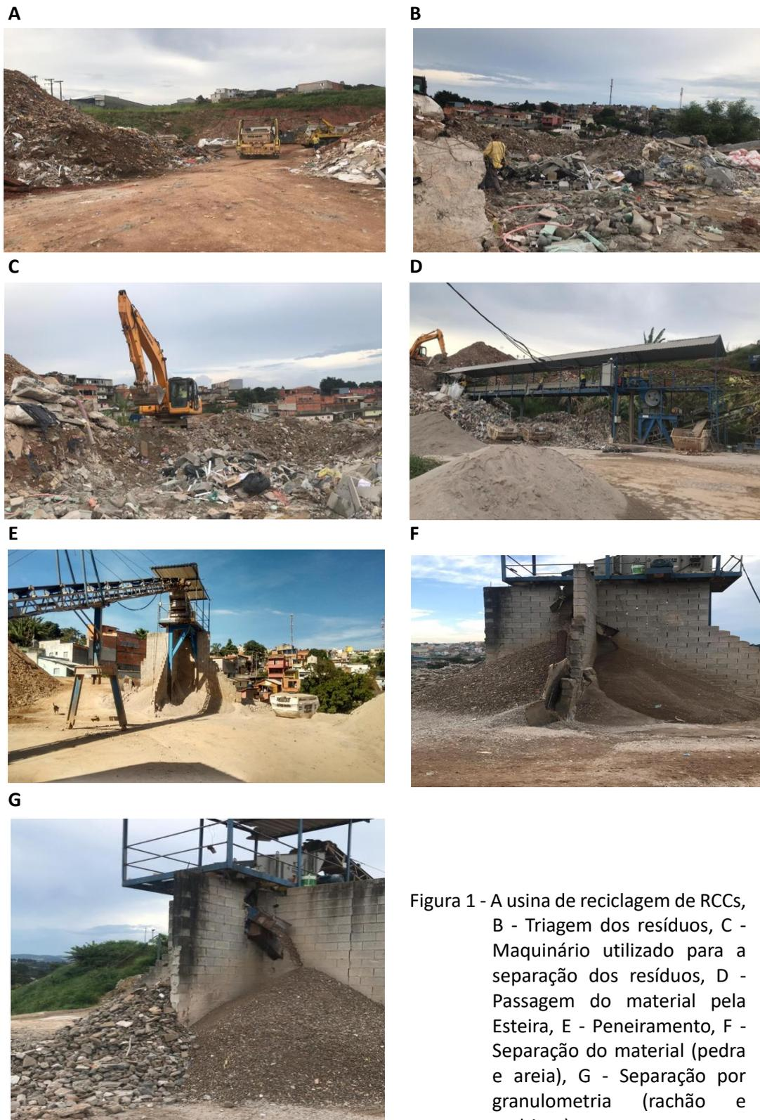
Figura 1 - A usina de reciclagem de RCCs, B - Triagem dos resíduos, C - Maquinário utilizado para a separação dos resíduos, D - Passagem do material pela Esteira, E - Peneiramento, F - Separação do material (pedra e areia), G - Separação por granulometria (rachão e pedrisco).
